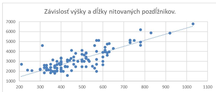
Obr.3.2 Závislosť výšky a dĺžky nitovaných pozdĺžnikov
