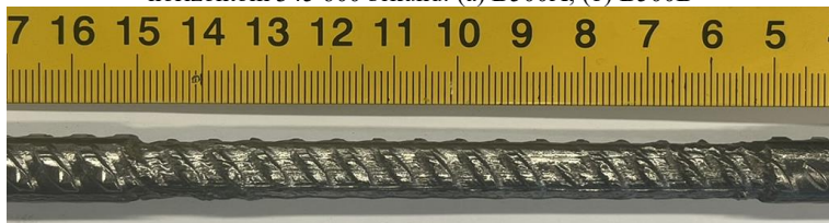
Obr. 20 Morfológia korózie, na vzorkách namáhaných elektrickým prúdom 0,1A a časovým horizontom 345 600 sekúnd: (a) B500A; (b) B500B
