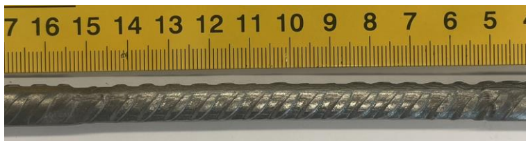
Obr. 19 Morfológia korózie, na vzorkách namáhaných elektrickým prúdom 0,1A a časovým horizontom 172 800 sekúnd: (a) B500A; (b) B500B
