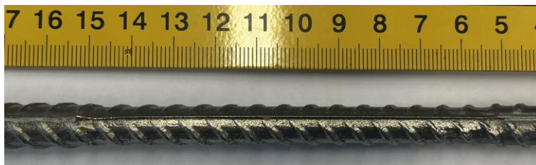
Obr. 20 Morfológia korózie, na vzorkách namáhaných elektrickým prúdom 0,1A a časovým horizontom 345 600 sekúnd: (a) B500A; (b) B500B
