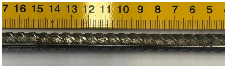
Obr. 19 Morfológia korózie, na vzorkách namáhaných elektrickým prúdom 0,1A a časovým horizontom 172 800 sekúnd: (a) B500A; (b) B500B
