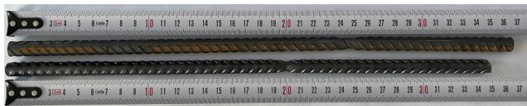
Obr. 14 Fotografia betónárskej výstuže po vykonaní ťahovej skúšky
