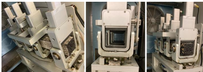
Obr.15 Zariadenie 4PB nachádzajúce sa v cestnom laboratóriu na ČVUT v Prahe
