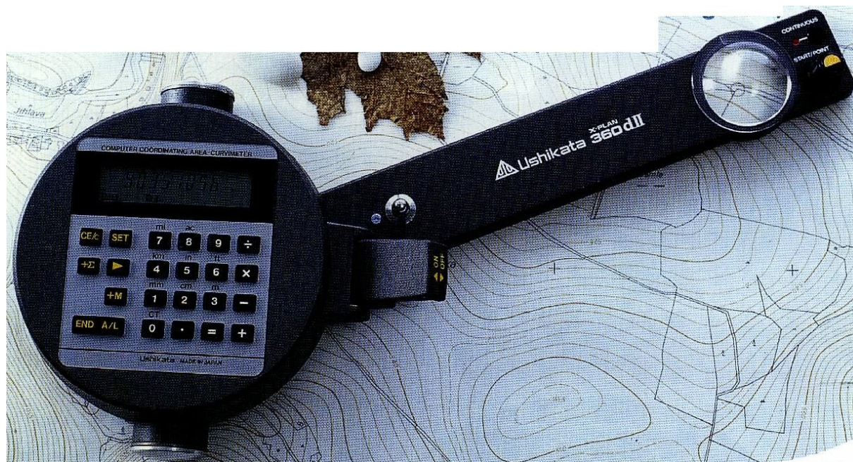
Obr. 11.13. Digitálny planimeter
