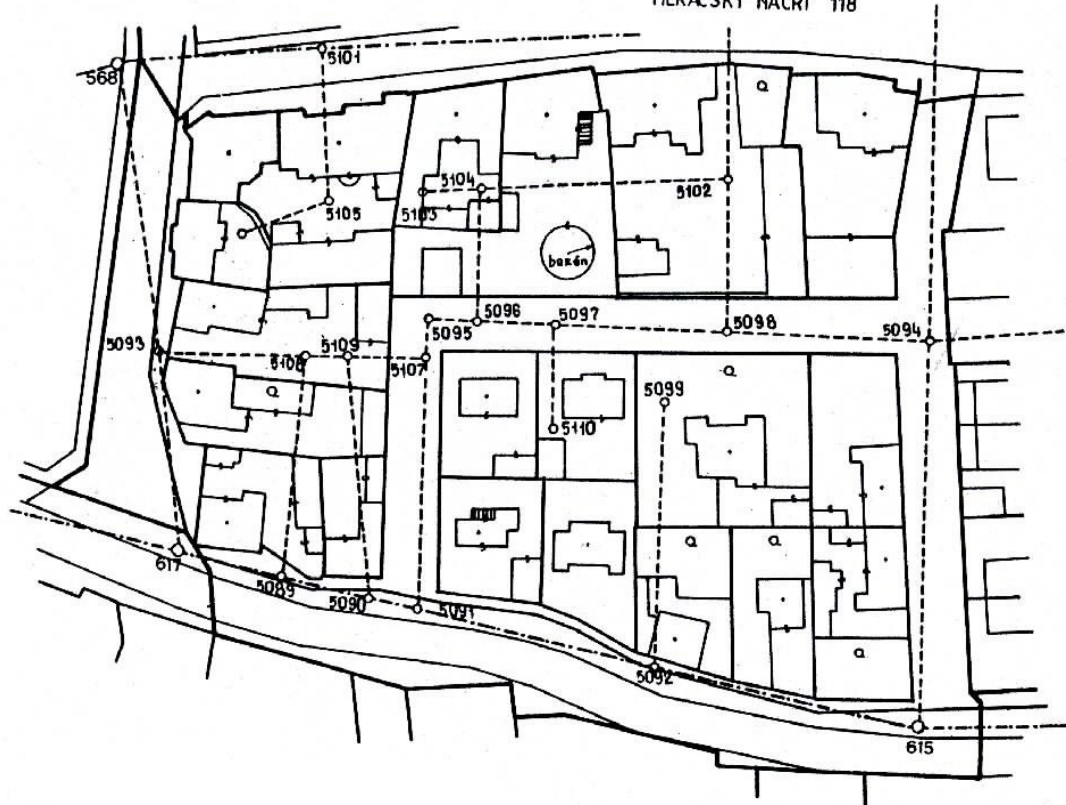
Do meračského náčrtu sa pred meraním zobrazí sieť podrobného polohového bodového poľa (polygónová sieť), ktorá sa v priebehu merania podľa potreby dopĺňa ďalšími meračskými bodmi a meračskými priamkami (obr. 9.5).
