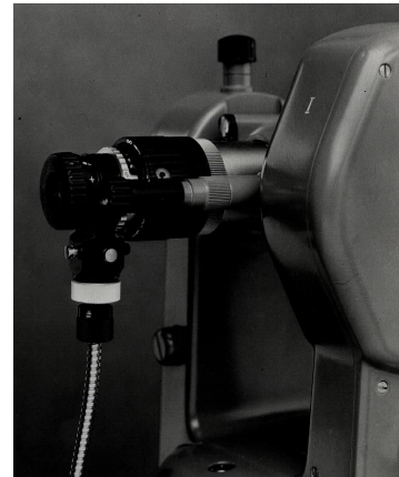
Obr. 12.67. Nasadzovací laserový okulár
